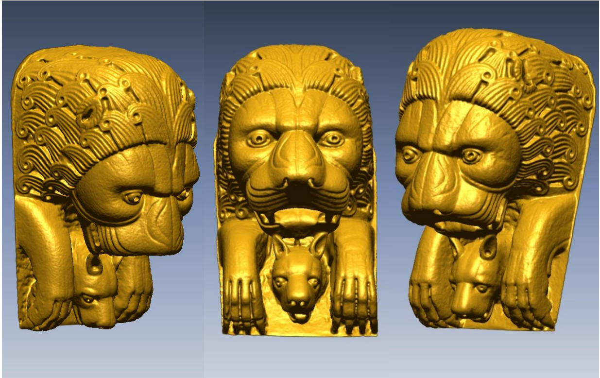
Figura 6.9: Creazione del modello a mesh tramite triangolazione della nuvola di punti ottenuta.
