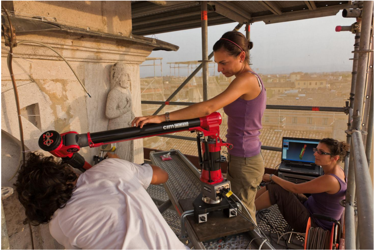
Figura 6.5: Fasi del rilevamento con laser scanner a triangolazione per la documentazione 3D dell'apparato scultoreo decorativo della torre Ghirlandina, Settembre 2011.
