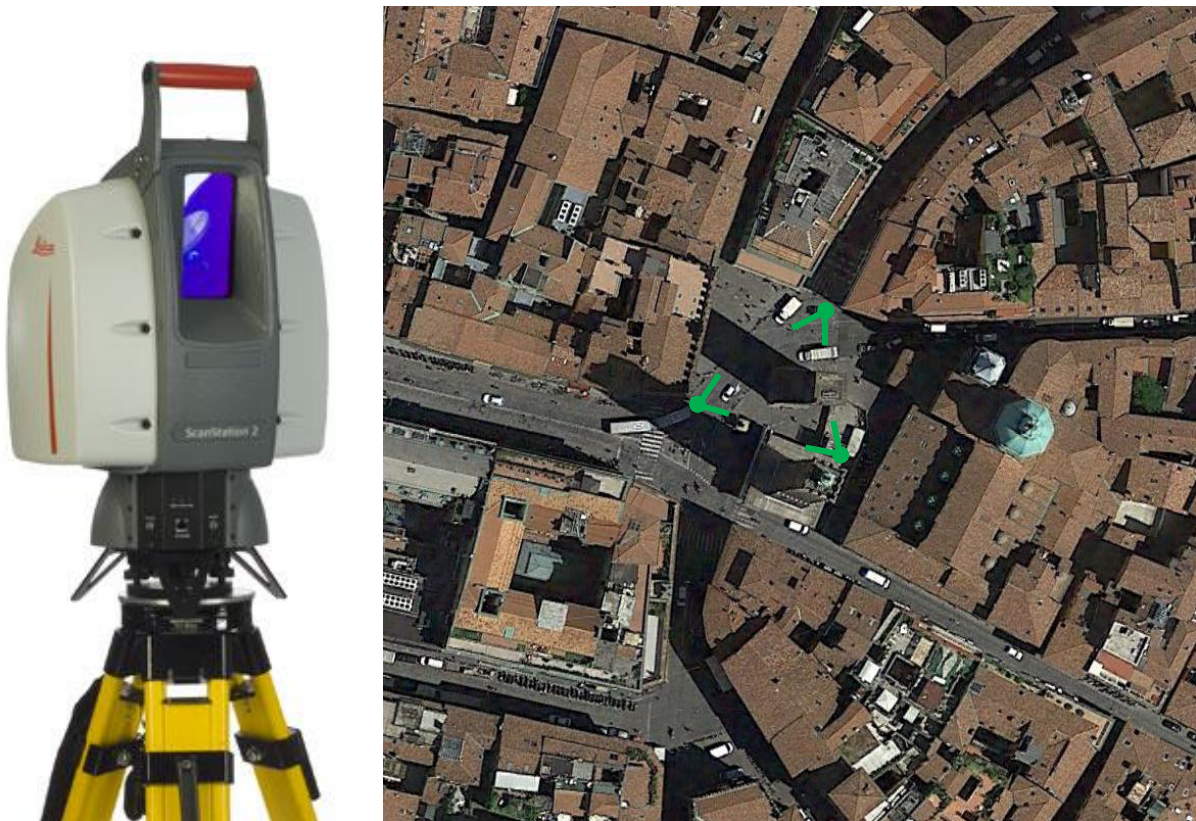
Figura 5.4: Leica ScanStation 2 e posizioni di scansione della campagna di Luglio 2009.
