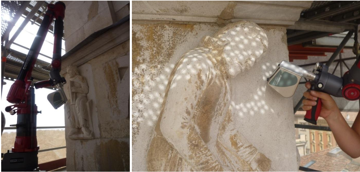
Figura 6.4: Strumentazione laser scanner a triangolazione con braccio articolato a 7 assi Romer CMM Infinite 2.0 e sensore ScanWorks Perceptron.
