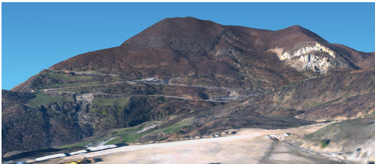
Figura 4.5: Modello Digitale del Terreno (DTM) foto-texturizzato con le ortoimmagini, ottenuto dai dati del rilievo Laser Scanning Aviotrasportato (ALS).
