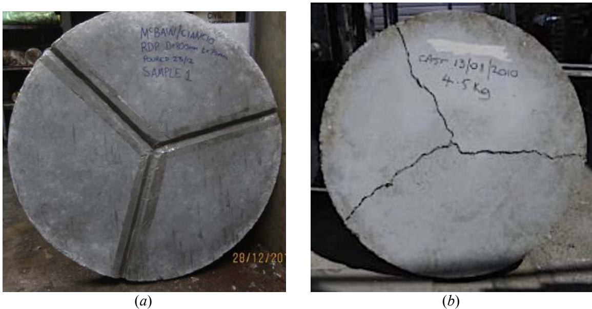
Figura 3.17: Prove di flessione RDP su lastre circolari in FRC - provino intagliato (a) e provino fessurato in seguito all'esecuzione della prova (b).
