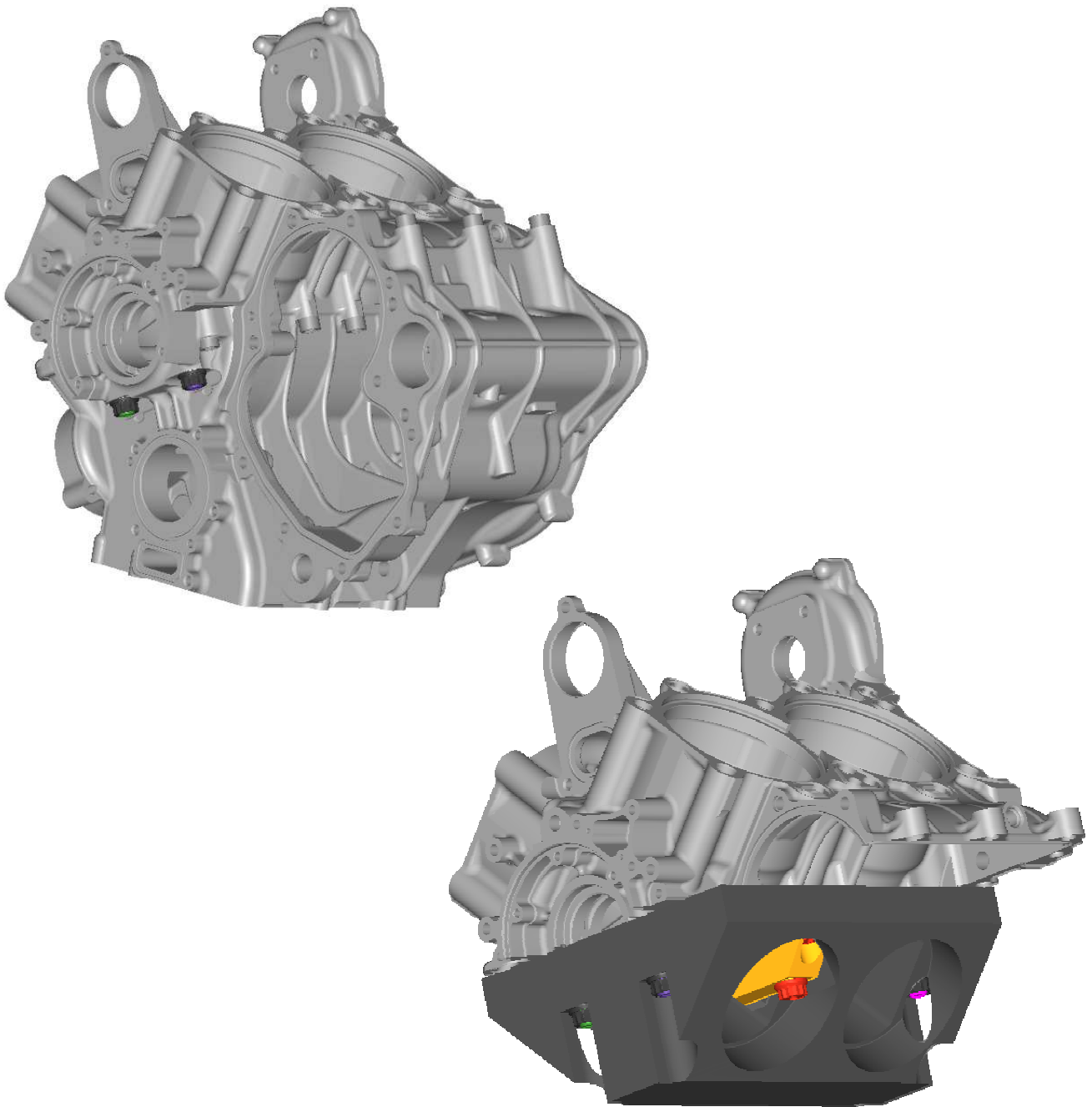
Fig.5.18 Configurazioni simulate per analizzare le deformazioni delle sedi delle canne dopo il serraggio del semicarterm-inferiore e del bottom-fixture
