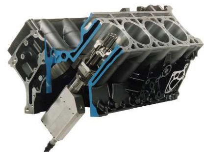
Fig.4.2 Descrizione dei coefficienti di Fourier per l'Incometer e esempio di lay-out per rilievo con Incometer
