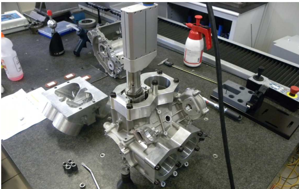
Fig.4.17 Configurazione BUILD1: Incometer posizionato sui torque-plates serrati a 5 Nm
