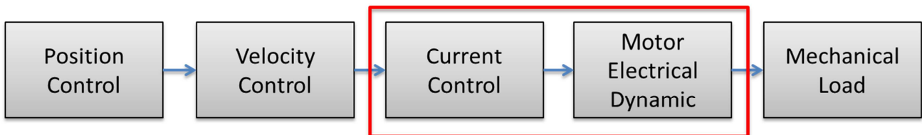
Figura 5.30: Loop di corrente e dinamica del motore all'interno di una schema semplificato
