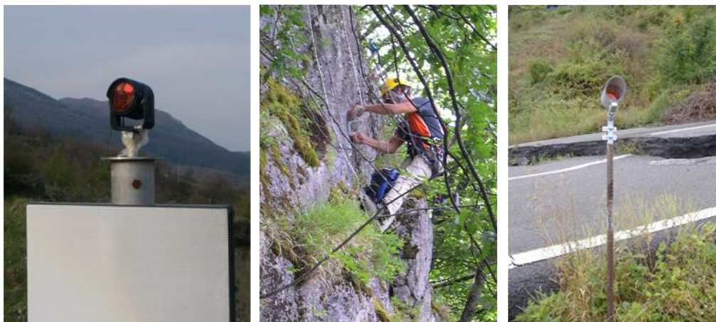
Figura 4.4: Esempi di prismi installati.
