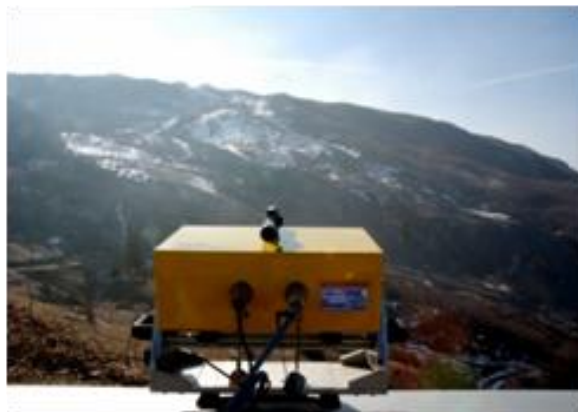
Figura 4.31: IBIS-L, puntamento verso il coronamento della frana.
