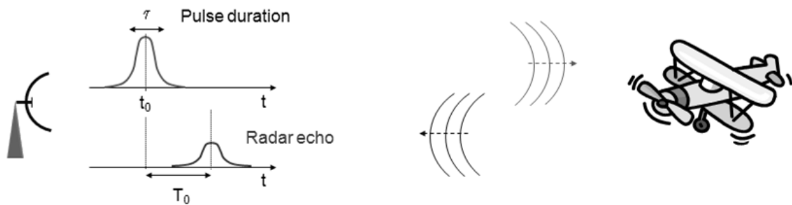
Figura 2.1: Schema esemplificativo del principio di funzionamento del radar.
