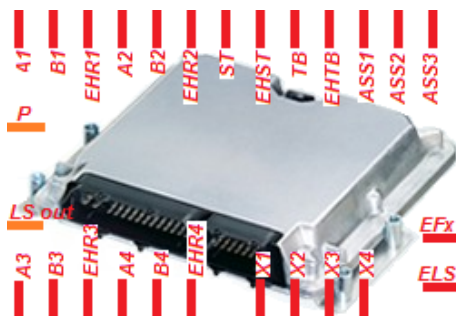
Figura 10.15. Centralina di controllo ECU
