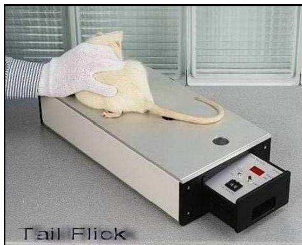
Figura 16 Apparecchiatura per il tail flick test e posizionamento dell'animale sul raggio termico.
