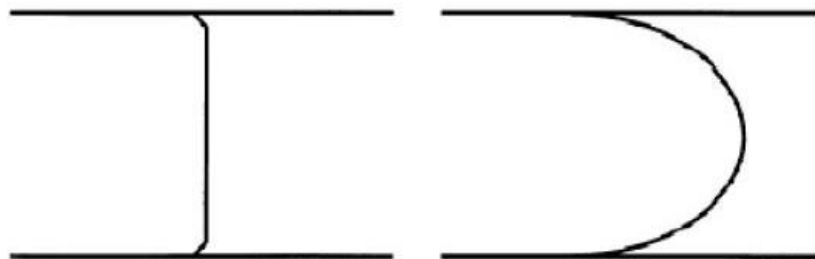
Figura 20 - A sinistra il fronte del flusso elettrosmotico; a destra quello laminare.
