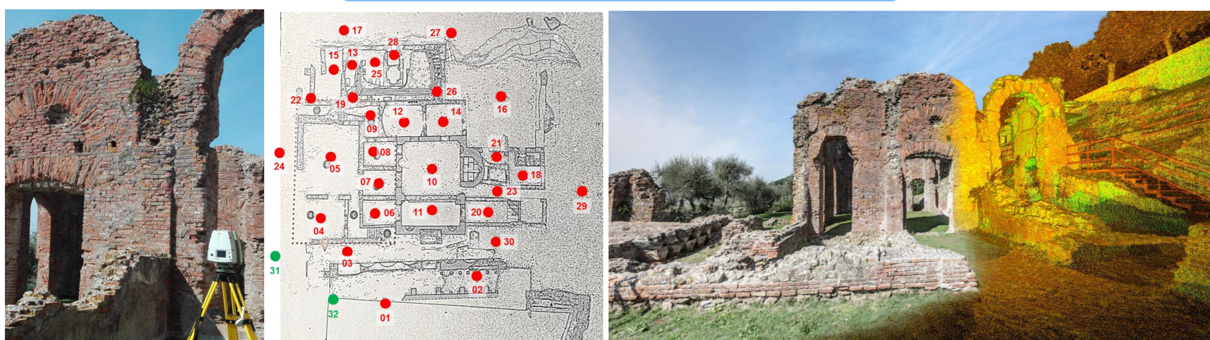
Figura 3. Rilievo laser scanning del complesso archeologico - da sinistra a destra: laser scanner in acquisizione; progetto di postazione scansioni; modello 3D a nuvola di punti con texture fotorealistica e in falsi colori.
