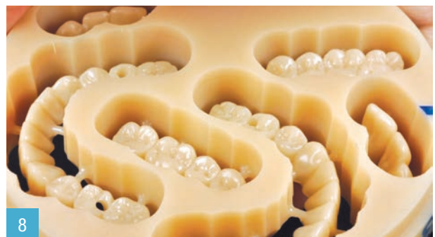
Fig. 8 Sovrastrutture protesiche in composito realizzate CAD/CAM con sistema per sottrazione dal pieno di blocchi fresabili prepolymerizzati.
