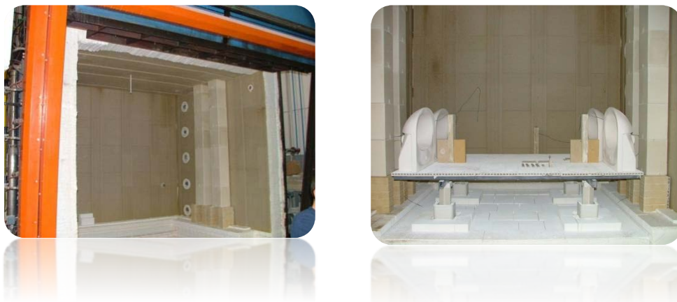
Esempio di forno intermittente per articoli sanitari
